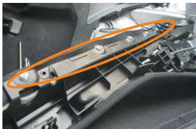
14 生地をプラスチックパートではさみ込んだ状態で、全てのネジを固定します。
