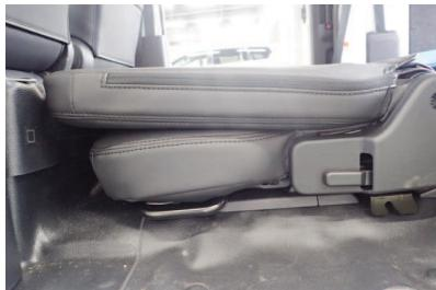
カバーを装着する事で、生地の厚みが増す為、シート格納時に背もたれを倒してロックを掛ける際、カバー装着前に比べ、ロックが掛かり辛くなってしまいます。
