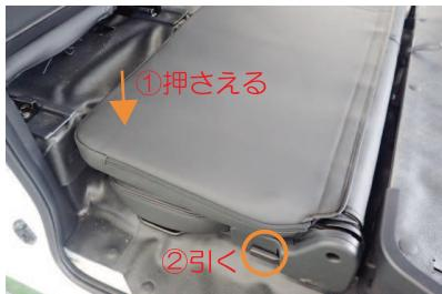
シートを起こす際も、ロック解除がし辛くなっていますので、①背もたれを押さえながら、②リクライニングレバー（図の○部）を引くようにして下さい。（背もたれを押さえずにリクライニングレバーを引こうとしてもレバーが動きません。）
