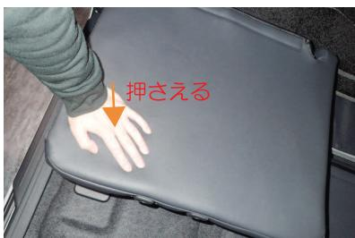
背もたれを倒し、図の手で押さえている辺りを上から押さえ付けるようにすると、背もたれのロックが掛けられます。
