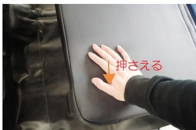
背もたれを倒し、助手席側背面の、図の手で押さえている辺りを上から押さえ付けるようにすると、背もたれのロックが掛かります。（運転席側背面を押しても、ロックが掛かりません。）この状態で、シートを格納するようにして下さい。
