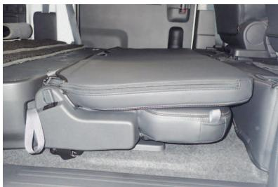
カバーを装着することで、生地の厚みが増す為、シート格納時に背もたれを倒してロックを掛ける際、カバー装着前に比べ、ロックが掛け辛くなってしまいます。
