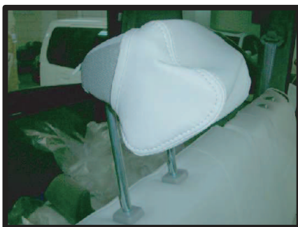
⑧2列目のヘッドレストは正面の下側からカバーをかぶせていきます。後は1列目と同様の取り付け方法で行ないます。
