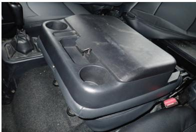
14 コンソールボックスを元の位置に取り付けます。カバーの生地端がコンソールボックスで隠れるように調整してから10ページ9番で外したネジを締め直します。
