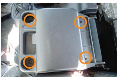
9 背もたれを倒して○印の4か所に留まっているネジをプラスドライバーで外し、コンソールボックスを外します。
