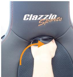
12 入れ込んだマジックテープ部分を下方向へ差し込み、シートに直接貼り付け固定します。
