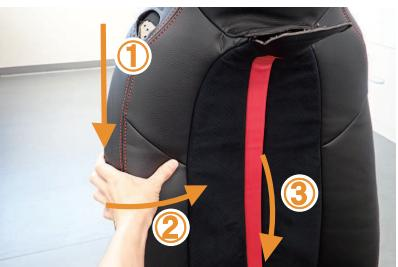
9 ①～③の順番に、カバー側面の生地を引き下げながら中央へ寄せて、中央で余った生地を下へ撫で下ろします。シートの下に余った生地を6番と同様にシート裏から引き出して、生地をシートに密着させていきます。
