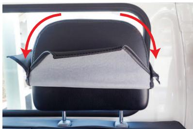
1 カバーは、板状のプラスチックパーツが付いている方が前側です。半分ほど裏返した状態で、ヘッドレストにかぶせます。ヘッドレストの先端までしっかりと入れ込んで下さい。
