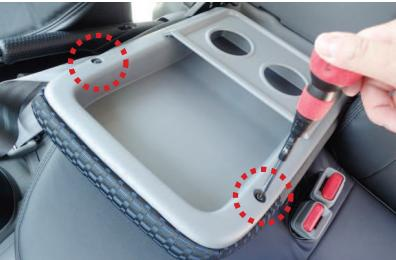
1 カバーをかぶせる前に、背面に付いているトレーを取り外します。
