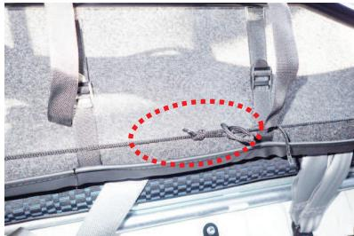
4 ベルトループにヒモを通した状態で左右のヒモを引き絞り、結び留めます。
