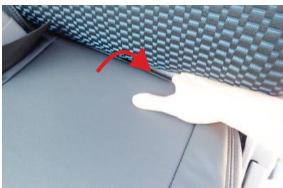
8 背もたれと座面の隙間に生地を入れ込みます。入れ込んだ生地に付いているマジックテープを、シートに直接貼り付け、固定します。
