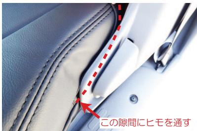
9 カバー両側面に付いているヒモをシートの側面を通して、後ろ側へ引き出します。外側面のヒモは、図のようにリクライニングレバーの内側を通します。
