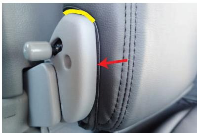
9 シート側面のヒンジ部の隙間にも、生地を入れ込みます。図の黄色線部分（ヒンジ上部）は隙間が狭いので生地は入れません。
