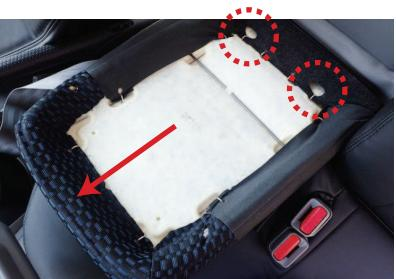
2 ネジを取り外し、トレーを前側にスライドさせると、トレーを固定しているツメ（図の○位置に固定されています）が外れ、トレーが取り外せます。
