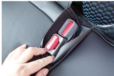
4 シートベルトバックルを、加工穴から取り出します。
