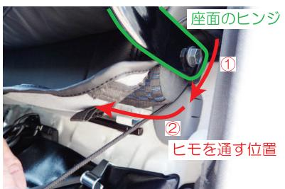
9 カバー両側面に付いているヒモは、図のように、①座面のヒンジ部の外側を通してから、②背もたれの裏側を通し、10番で説明するベルトループに通します。
