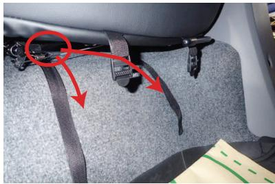
10 ③番で引き出した生地に付いているベルトを、座面下を通して前側に引き出します。座面下が狭いので、ベルトは2本とも、外側よりの図の○位置から通すようにし、その後、左右に引き出しますようにします。引き出したベルトと、カバー前側に付いているバックルを固定します。
