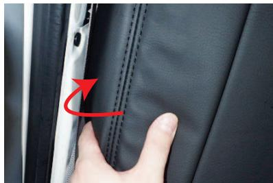
6 シート側面と車体の隙間に生地を入れ込み
