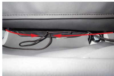
11 シート両側面から通したヒモを、シート後ろ側で結び留めます。
