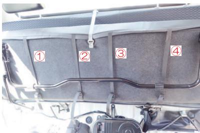
2 シートを跳ね上げ、カバー前後に付いているベルトを固定します。（①～④の計4箇所）
