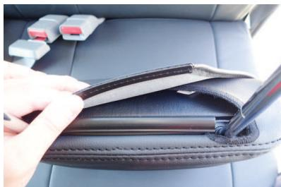
3 ヘッドレストをシートから取り外し、カバーを底面のプラフレームで固定します。
