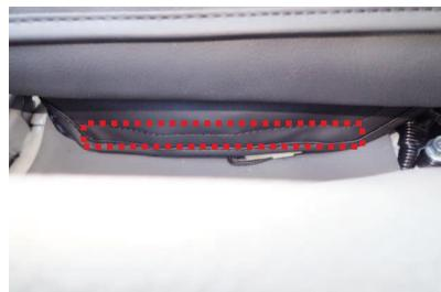
12 ヒモを結び留めた後に、8番で固定したマジックテープの付いた生地を、ヒモを覆うようにして固定し直します。
