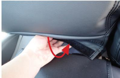
4 カバー前側のマジックテープが付いた生地を、シートの隙間から後ろ側へ入れ込みます。
