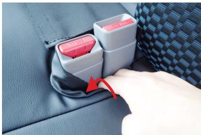
13 シートベルトバックルの隙間に生地を入れ込みます。
