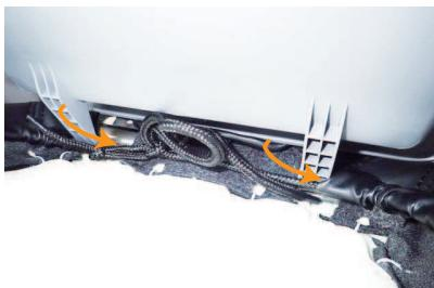
8 1番で取り外したバックボードを元に戻します。この際、5番で結び留めたヒモの上側にツメを通して下さい。
