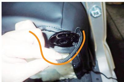
9 2番でボルトを外した金属部分の下側に、ヒモを通しておきます。
