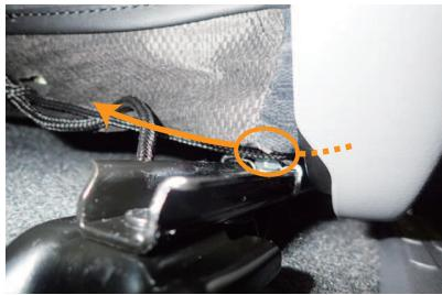
7 引き出したヒモは、図のようにシートとシートレールの隙間（図の○位置）に引っ掛けないようにします。
