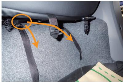
10 ③番で引き出した生地に付いているベルトを、座面下を通して前側に引き出します。座面下が狭いので、ベルトは2本とも、外側よりの図の○位置から通すようにし、その後、左右に引き出すようにします。引き出したベルトと、カバー前側に付いているバックルを固定します。
