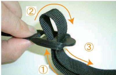
11 ベルトの固定方法は、図の①～③の順番にベルトをバックルに通し、引く事でベルトが締り固定されます。
