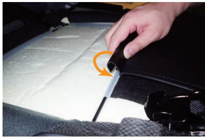
7 カバー背面側に付いている全てのプラフックは、純正シート生地を固定しているプラフックの上から引っ掛け、固定します。
