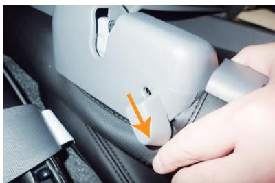
9 バックボードを戻す際は、側面のレバーを押し下げた状態で戻すようにすると、バックボードがレバーに引っ掛かりにくくなります。
