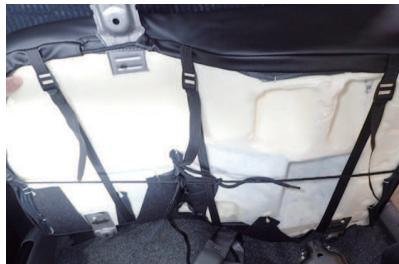
10 シート底面で、図のようにヒモとベルトを固定します。
