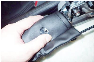
7 カバーの加工穴が、ネジ穴位置に合うように調整します。
