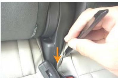
15 シートの付け根部分の生地を、ヘラ等を使用して、シートとプラスチックの隙間に入れ込みます。
