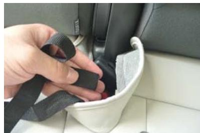
5 シートベルトバックルが収納されている箇所にベルトを通します。
