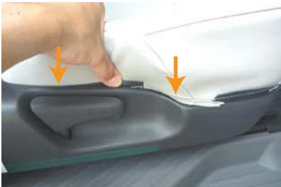
14 カバー側面の生地に付いている固定部材を生地ごとシートとプラスチックの隙間に入れ込みます。
