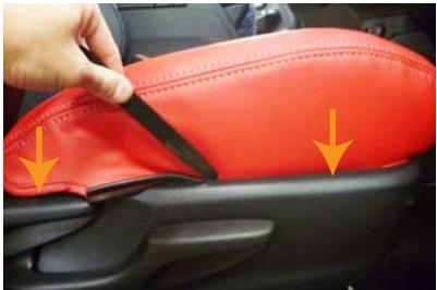
7 カバー外側面の固定部材の付いた生地を、ヘラ等を使用し、シートとプラスチックの隙間に入れ込みます。後ろ側の生地も同様に隙間に入れ込んで下さい。
