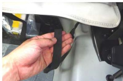
5 引き出した生地に付いているベルトを、シート裏を通して前方に回します。
