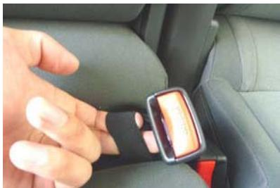
1 シートベルトバックルを、固定しているゴムから外します。
