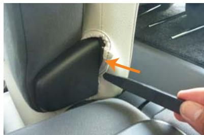
10 シートの内側面です。図の隙間に生地を入れ込みます。
