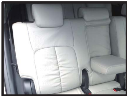
㉔カバーのラインを整えて、2列目運転席側背もたれの完成です。助手席側も形状は異なりますが、同様の固定方法で取り付けます。
