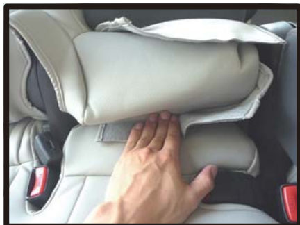
⑦アームレスト下の生地も背もたれと座面の隙間に生地を入れ込みます。
