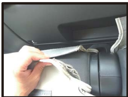
⑨引き出した生地を、カバー背面下の生地とマジックテープで固定します。
