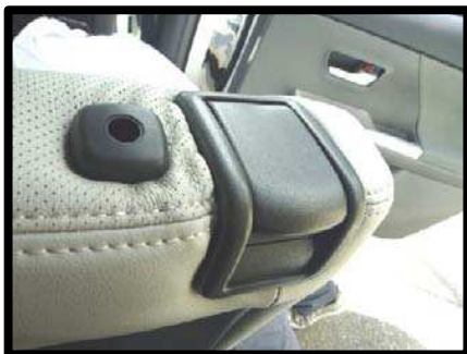
⑯レバーのフチに生地を全て入れて、レバーのネジを締め、元通りに固定して下さい。
