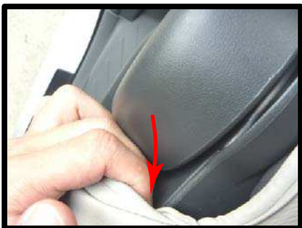
⑮シート側面の付け根部分です。生地を隙間に食い込ませるように入れ込みます
