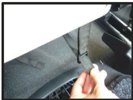
⑨ベルトをシート背面から引き出して1ページの⑤で引き出した生地についているバックルに通して固定します。
