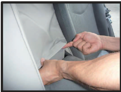
⑳引き出した生地とアームレスト収納部の下の生地を、マジックテープで固定します。
