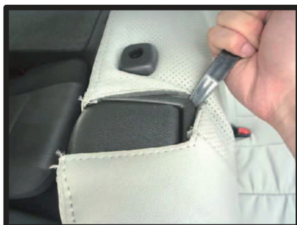
⑯シート肩口のレバーのフチに生地を入れ込みます。ヘラなどを使用して作業を行なって下さい。
