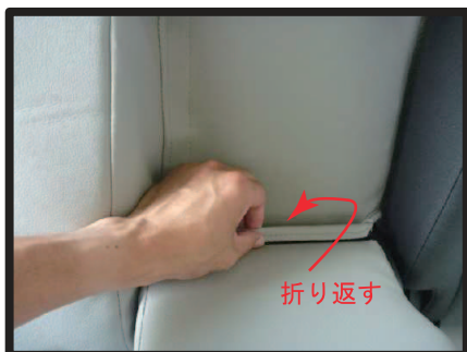
⑤カバーをプラスチックフックで固定し ます。アームレストを倒した際に上 になる生地を折り返して、④で引き出 した生地に付いているフックに挟み込む ようにします。
