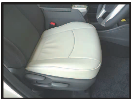
⑫シートのラインを整えて、1列目運転席側座面の完成です。助手席側も同様に取り付けます。
