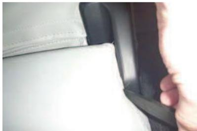
**7** アームレスト軸部分の生地を、ヘラなどを使用して隙間にしっかり入れ込みます。
