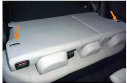
20 図のシートを固定する受けの部分にカバーの加工穴があっているか確認して下さい。加工穴は少し大きめに開けていますが、ずれて受け部分を塞いで使用すると、生地が破れる恐れがあるので、ご注意ください。
