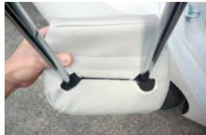
**11** 2列目ヘッドレストの裏は図のようになります。2列目ヘッドレストはカバーをかぶせやすくするために、軸周りの穴を大きめに開けています。
