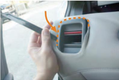
18 リクライニングレバーのフチに、ヘラなどを使用して生地を入れ込みます。リクライニングレバー部のプラスチック部はツメが外れやすくなっているので、作業は慎重に行ってください。
