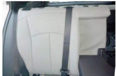
21 カバーのラインを整えて、2列目運転席側背もたれカバーの完成です。アームレスト収納部はアームレストカバー装着後、アームレストをしばらく背もたれ側に収めた状態にしておくことで生地がシートに馴染んでいきます。
