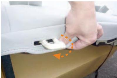
**7** シート背面の図のコの字型のフックにカバーの加工穴を通します。
