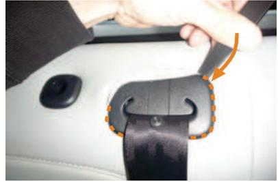
19 中央シートベルトのフチに、ヘラなどを使用して生地を入れ込みます。中央シートベルトのプラスチック部はツメが外れやすくなっているので、作業は慎重に行ってください。
