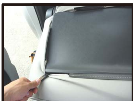
⑪シート背面のバックボードの隙間に生地を入れ込みます。プラスチックの板を入れ込むことで、生地がはみ出さずに固定されます。
