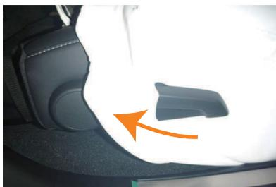
**9** 運転席側から取り付けを行います。カバーの加工穴にリクライニングレバーを通します。
