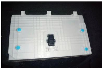
**7** バックボードを取り外すと図の様になります。ラゲッジにボードを倒した状態で作業を行います。この時に中央に付いているチャイルドシート用のアンカーカバーを取り外しておきます。
