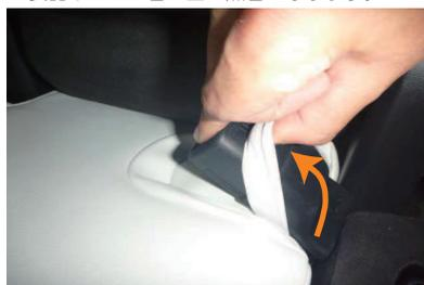
**22** カバー奥に付いているゴムを中央のシートベルトバックルに通して固定します。カバーのラインを整えて、運転席側座面の完成です。助手席側は一部固定方法が異なる為**23番**をご覧ください。
