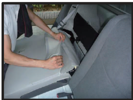
⑧ ⑩で引き出した生地を背もたれ背面とマジックテープで固定します。
