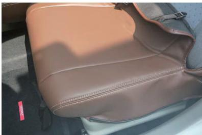
1 始めに5ページ1番と同様にシート底面のゴムを外しておきます。カバーをシートのラインに合わせて前側から後ろへかぶせます。
