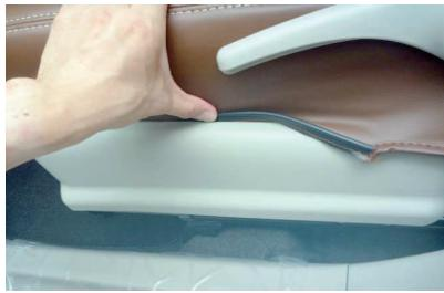
7 カバー外側の固定用の部材をシートとプラスチックの隙間に入れ込みます。
