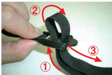
14 ベルトは①～③の順番でバックルに通します。まずバックルの中央にベルトを通して折り返します。次につまみ側の端に通して引くとカバーの前後が絞り込まれ固定されます。ベルトは強く引きすぎると生地が破れたり、切れたりするのでご注意下さい。
