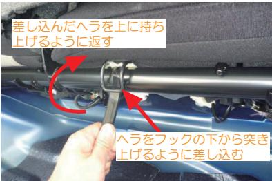
7 シートの背面側の付け根に、図のフックが金属バーに掛かっています。フックの下側にヘラなどを差し込み、てこの原理のよう にヘラを動かして、フックを金属バーから外します。
