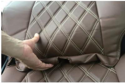
7 背もたれと座面の隙間に生地を入れ込みます。生地の端には大きなフックが付いてるので、フックの角などで生地を傷付けないようにご注意下さい。
