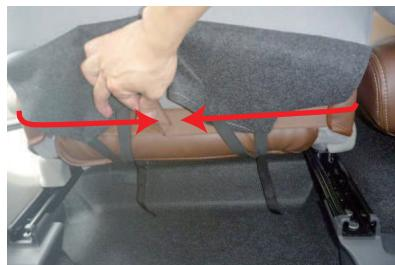
10 カバー側面の後ろ側に付いているマジックテープ同士を、図のようにシート背面から中央へ寄せて固定します。
