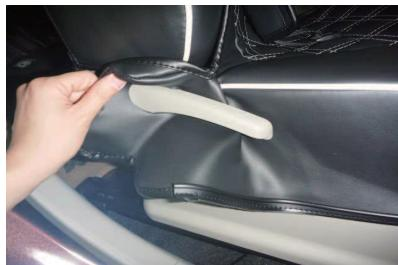
4 リクライニングレバーをカバーの加工穴に通します。カバーの加工穴は予め小さめに開けている為、レバーを通す際は慎重に作業を行って下さい。
