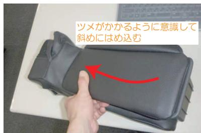
12 ボックスをアームレスト側のカバーの生地を巻き込みながら、アームレストに戻します。この際ボックス裏のツメがしっかりとかかるように意識して、元に戻して下さい。
