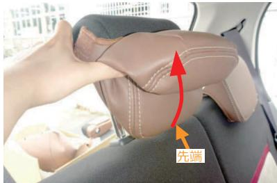
7 2列目中央ヘッドレストです。2列目ヘッドレストは図の矢印の方向に、下から上へかぶせます。まずヘッドレストの先端部分の生地に、たるみなどが出ないようにしっかりとかぶせます。
