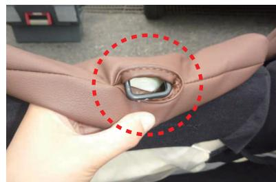
11 7番の作業で外したフックに、カバーの加工穴を通します。
