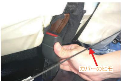
20 シートの前側を上げて、シートベルトバックルをシートのくぼみに入れ込みます。カバーを固定するヒモをかわしながら入れ込んで下さい。
