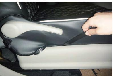
9 カバー側面の固定用の部材をシートとプラスチックの隙間にに入れ込みます。
