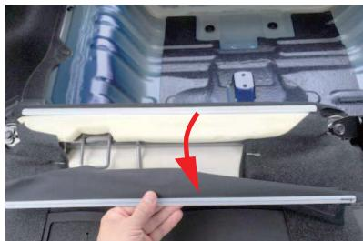
7 シート表皮をめくり上げると図のようにシートのスponジ部分が見えます。
