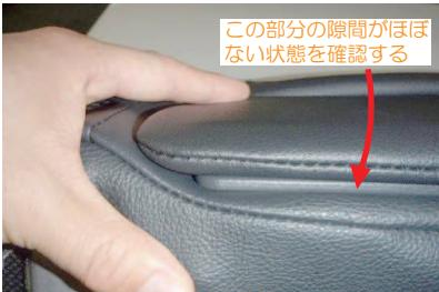
13 ボックスをアームレストに戻した際に、図の矢印の隙間がほぼない状態になっていることを確認して下さい。ボックスが少し浮いた状態の場合は、ボックス裏のツメがかかるかもしれません。再度ボックスを取り付け直して下さい。
