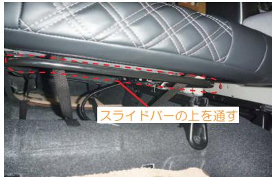
10 カバー前側に付いているベルトを座面下のスライドレバーの上を通して、背面へ回します。
