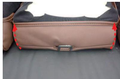
12 シート中央の付け根部分にカバーを包み込むようにかぶせます。
