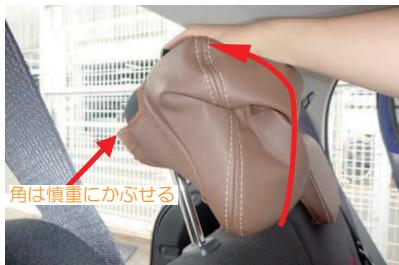
8 ヘッドレスト全体にカバーをかぶせます。ヘッドレスト後ろ側の角部分は、一番装着がきつくなるところです。角の部分を指で押し込みながら、慎重にカバーをかぶせて下さい。
