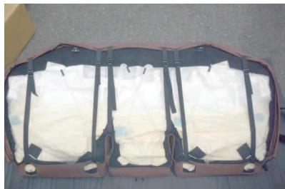
14 カバー前後のベルト6本を固定します。ベルトの固定方法はアページ14番を参考にして下さい。
