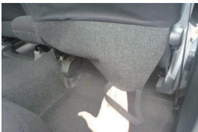
1 背もたれ背面からシート裏に固定されている生地を外します。生地はシート裏の金属部分に、ゴムで引っ掛けで固定されているので、ゴムの固定をほどき生地を外します。
