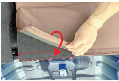
14 13番でめくり上げていた生地を元に戻して、カバーに付いているマジックテープをシートに直接貼り付けて固定します。
