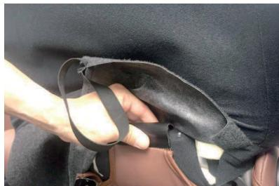
12 8番で引き出した生地に付いているフックを、図のようにシート背面裏の縁に引っ掛けで固定します。座面カバーを装着する際に外した5ページ1番の生地を、ゴムが完全には外れていませんが、しっかりとめくり上げて作業を行って下さい。
