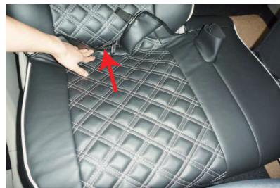
5 背もたれと座面の隙間に生地を入れ込みます。背もたれの角度を調節して入れ込みやすい角度で行って下さい。
