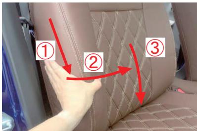
9 ①～③の順番に、カバー側面の生地を引き下げながら中央へ寄せて、中央で余った生地を下へ撫で下ろすようにして、生地をシートに密着させていきます。カバー側面のシワが無くなるまで、繰り返し行って下さい。
