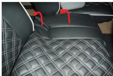
2 アームレスト下のシートのフチにカバーを引っかけるようにしてかぶせます。
