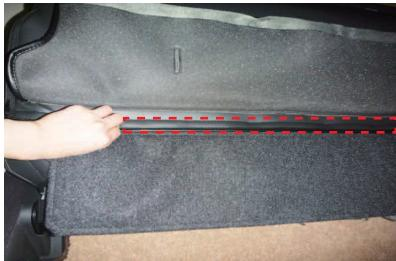
13 カバー背面の生地をめくり上げて、図の点線の位置にカバーのマジックテープを、シートに直接貼り付けて固定します。
