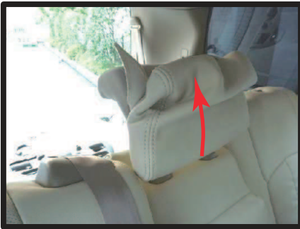
※2列目センターヘッドレストは、始 めにヘッドレストの先端にカバーを かぶせて、矢印方向に持ち上げるよ うにかぶせていきます。
