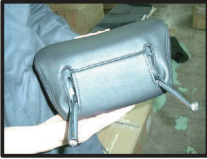
⑦プラスチックのフックを取り付けた状態です。
