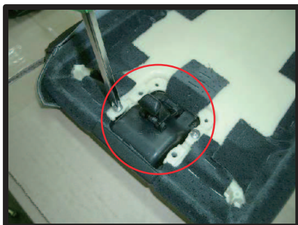
⑭フタの開閉レバー部分を取り外します。 +ドライバーを使用します。
