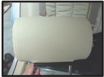
⑫カバーをかぶせ、ラインを整えます。 1列目と同様にカバーを固定し、2列目ヘッドレストの完成です。
