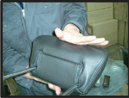
⑧19ページ②・③で、ヘッドレスト本体を圧縮しましたので、手のひらでたくようにしてカバーの中身をならしていきます。
