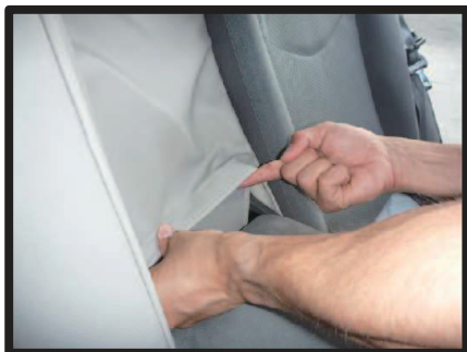
⑰引き出した生地とアームレスト収納部の下の生地を、マジックテープで固定します。
