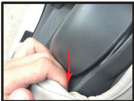
⑪シート側面の付け根部分です。生地を隙間に食い込ませるように入れ込みます
