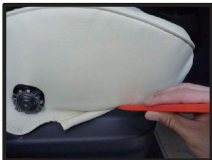
⑧カバー外側面の生地をシートと土台部分のプラスチック部の隙間に入れ込みます。ヘラなどを使用して作業を行うと生地が入れ込みやすくなります。
