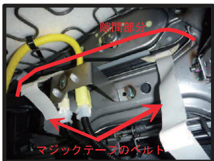
⑪図はシートの裏側からシートの内側部分を写しています。カバー内側面の生地をプラスチック部の隙間に入れ込みます。カバー内側面に付いているマジックテープのベルトを、図の隙間部分からシート裏に引き出します。
