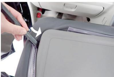
**8** シートバックテーブルのフちに、端に固定部材の付いた生地を入れ込みます。
