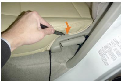
**5** 側面の生地をヘラ等を使用して、シートとプラスチックカバーの隙間に入れ込みます。内側面も同様に行います。
