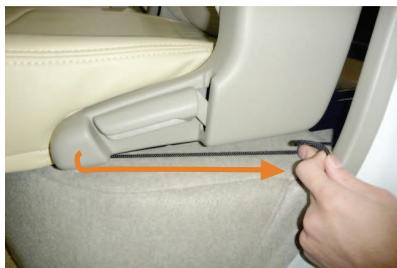
**6** 側面のヒモをプラスチックカバーの下を通し、背面へ出します。内側面も同様に行います。
