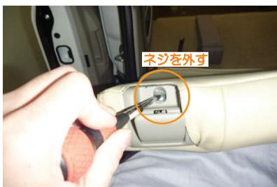
**12** シートの肩口に付いている、リクライニングレバーをドライバー等を使用して外し、カバーの加工穴から取り出します。
