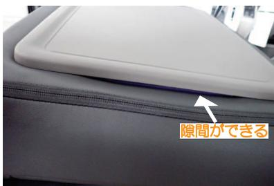
**10** シートの背面下です。シートバックテーブルの内側に入れ込んだ固定部材はある程度厚みがあるため、図のように隙間ができます。固定部材が無いと生地がはみ出しやすくなるため、ご理解下さい。
