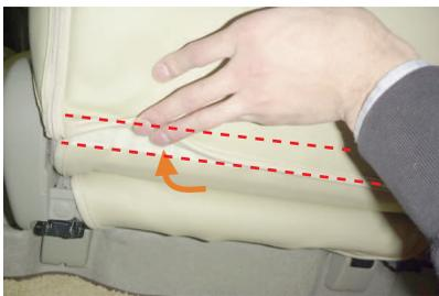
**9** 10ページ6番で引き出した生地が付いているマジックテープと、カバー背面下に付いているマジックテープを固定します。マジックテープの固定位置は、シートを1番後ろまで倒した時に、生地が座面に干渉しない位置に合わせています。
