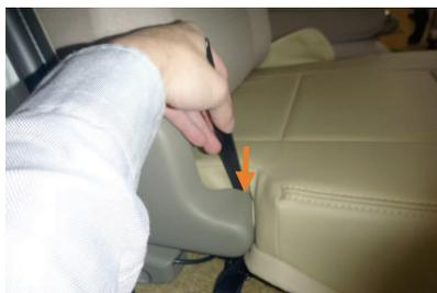
**5** カバー外側面の生地をヘラ等を使用して、シートとプラスチックカバーの隙間に入れ込みます。
