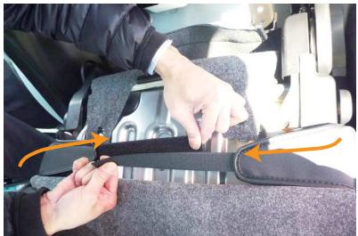
7 6番で外した純正シートの表皮をめぐり上げます。シート背面のフレームが見えた状態で、カバー両側面の生地を背面側に回しマジックテープ同士を貼り付けて固定します。
