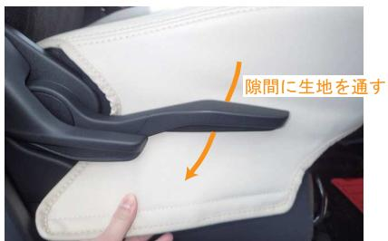
9 外側面の生地を、シートリフターのレバーとシートの隙間に通します。
