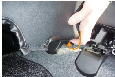
4 カバー外側面の後ろ側と、内側面に付いている固定フック（計3箇所）をシートのフックに引っ掛け固定します。（図は内側面）詳しい固定方法は5番を参照して下さい。※内側面の後ろ側のフックを固定する際は背もたれを前に倒して下さい。
