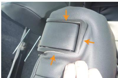
2 カバーをシート全体にかぶせ、リクライニングレバーとシートの隙間に生地を入れ込みます。
