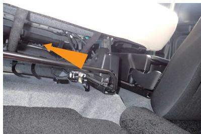
12 カバー前面に付いているベルト3本を、シート裏から背面側に通します。この時、スライドレバーや配線に干渉しないようにして下さい。
