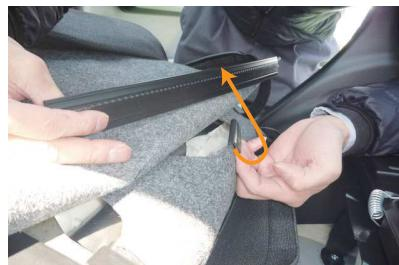
6 シート背面下部の純正シートの表皮を固定しているブラフックを外します。
