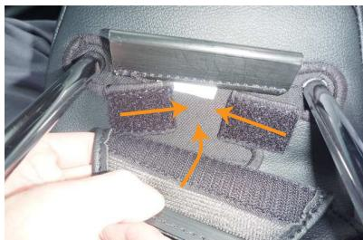
8 ヘッドレストを台座から外し、カバー裏のマジックテープを固定します。
