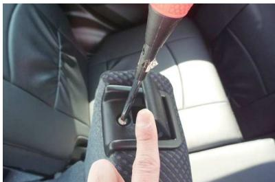
1 ドライバーを使用し、リクライニングレバーの固定ネジを外します。
