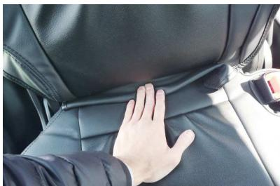
3 背もたれと座面の隙間に生地を入れ込みます。
