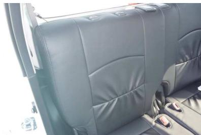
12 リクライニングレバーを外した時と逆の手順で戻し、カバーのラインを整えて、2列目運転席側背もたれの完成です。助手席側も同様に取り付けます。
