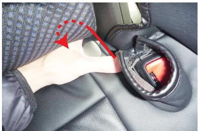
2 シートの後ろ側にカバーを引っ掛けるようにしてかぶせます。
