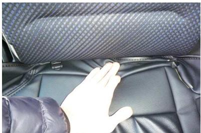
1 座面と背もたれの隙間に生地を入れ込みます。
