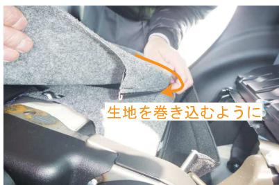
8 6番で外した純正シートの表皮を固定しているフックを元に戻します。
