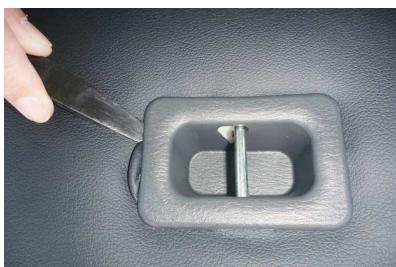
11 シート背面のチャイルドシートの固定用アンカーの隙間に生地を入れ込みます。
