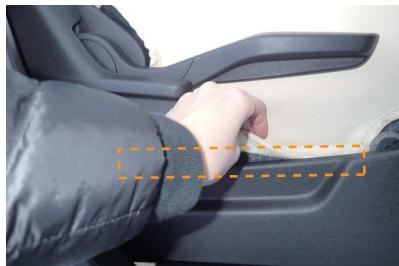
10 カバーの裏に付いているマジックテープを純正表皮に直接貼り付け固定します。この時、生地の端がプラスチックカバーで隠れるように、プラスチックカバーの隙間に生地を入れ込むようにして下さい。
