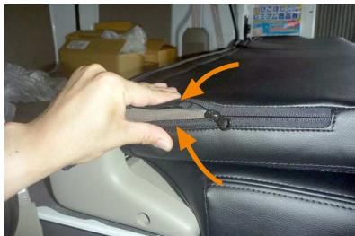
4 カバー側面のファスナーを、生地を内へ寄せながら慎重に閉じます。ファスナーの端はカバーの中へ入れ込みます。
