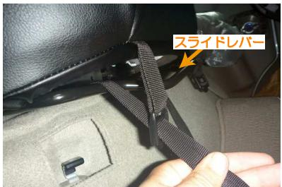
14 引き出したベルトを、カバー前側に付いているバックルに通して固定します。ベルトはスライドレバーの上を通すようにして固定して下さい。
