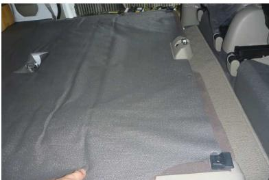
1 シートを格納した状態にします。シート裏を覆っているピニールの生地を外します。
