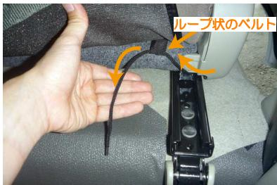
7 5ページ3番で引き出した生地をめぐり上げると、カバーの裏にループ状のベルトが付いています。ベルトのループに側面から引き出したヒモを通します。ベルトは見えづらい場合があります。**3番**の生地をしっかりと引き出して確認して下さい。
