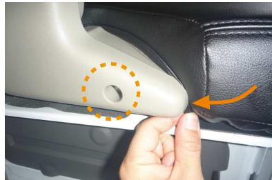
10 側面のプラスチック部に生地を入れ込みます。入れ込みづらい場合は丸印部分のネジをドライバーで緩めると生地が入り込みやすくなります。
