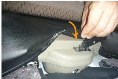
6 シート背面からの図です。座面のロックを解除するレバーのプラスチック部のフチに生地を入れ込みマジックテープで直接シートに貼り付けて固定します。
