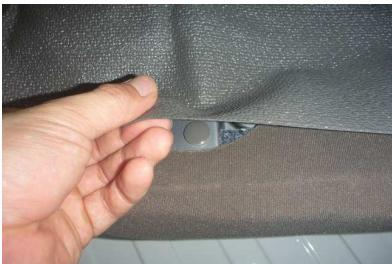
2 ピニールの生地はリベットピンで固定されています。ピンを抜くか、ピンの隙間から生地を外します。生地が破れやすいので、作業は慎重に行って下さい。
