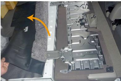
3 図のようにシート裏のピニールの生地を外してめくり上げます。
