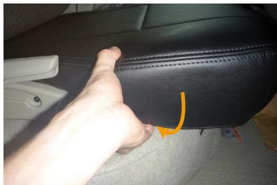
17 カバー下回りのヒモが通った生地を、シートのフチに巻き込むようにしてなじませます。
