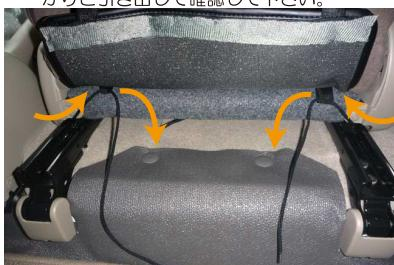
8 両側面のヒモを図のようにベルトのループに通して下さい。
