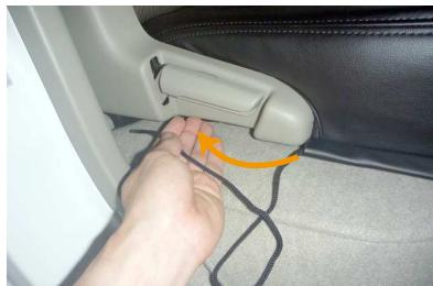
5 カバー外側面から出ているヒモを、図のようにシート背面へ回します。
