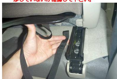
12 5ページ3番で引き出した生地の端に付いているベルトを、シートの裏を通してシートの前側に回します。シート裏はレールの内側に若干隙間がある程度で、あまりベルトを通す隙間はありません。どうしてもベルトが通らない場合は、長細い棒でベルトを押す、もしくは引き出すと作業が早くなります。
