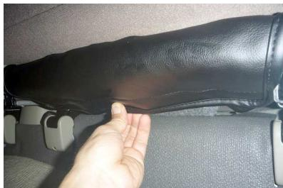
16 5ページ3番で引き出した生地の端にマジックテープが付いています。マジックテープを直接シートに貼り付けて固定します。
