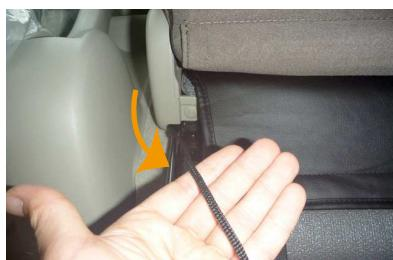
6 カバー内側面から出ているヒモも、シート背面へ回して、シート背面から引き出します。
