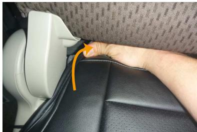
5 シートの付け根部分に生地を巻き込むようにかぶせます。
