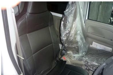
1 側面のファスナーを開けた状態で、シートのラインに合わせてカバーをかぶせます。
