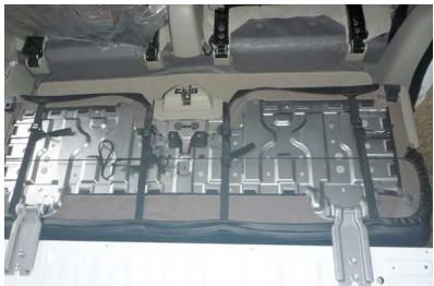
8 シートを格納した状態にします。シートの裏でカバー側面から出ているヒモと、前後のベルト4本を固定します。
