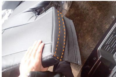
10 カバーの後ろ側の生地裏に付いているマジックテープをシートに直接貼り付けて固定します。8ページ3番で外した純正生地は中に入れ込みます、カバーの外に出しておきます。
