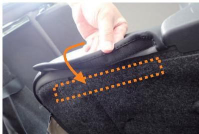
10 カバーに付いているマジックテープをシートの裏側に直接貼り付けて固定します。
