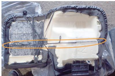
11 カバーの左右から出ているひもを、座面裏で固定します。
