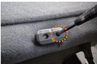
9 ゴムパーティは、ネジで固定されていますので、プラスドライバーでネジを外す事で、取り外せます。
