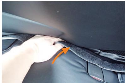
4 背もたれと座面の隙間に生地を入れ込みます。背もたれの角度を調整して入れ込みやすい位置で行って下さい。
