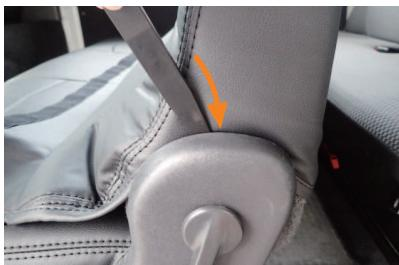
3 ヘラ等を使用し、プラスチック部の隙間に生地を入れ込みます。座面と同様に、隙間が狭く入れ込み辛い場合は、プラスチックカバーを固定しているネジを緩めて作業して下さい。
