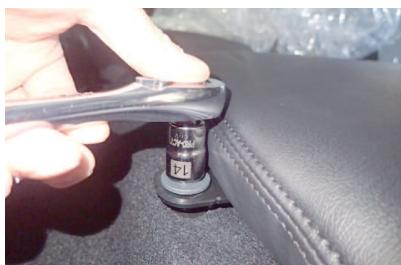
2 キャップを外した所にあるボルトを、ソケットレンチ（14mm）を使用して外します。
