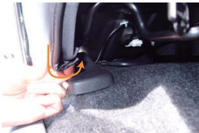
7 カバーの外側面の生地裏に付いているブラフック（2個）を、座面のフチにはめ込み固定します。詳しい固定方法は、8番～10番をご覧下さい。
