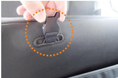
2 カバー背面の加工穴から、図のようにシート固定用バックルを取り出します。
