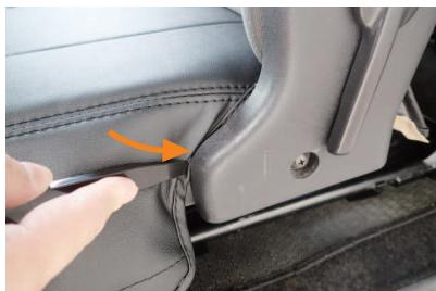
8 ヘラ等を使用し、プラスチック部の隙間に生地を入れ込みます。
