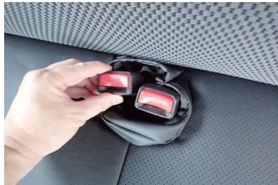
4 カバーの加工穴からシートベルトを取り出します。
