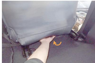
11 生地を座面裏に入れ込み、金属フックを座面裏で固定します。
