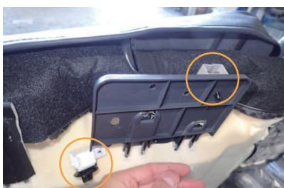
6 シートヒーター装備車は、座面の裏に配線が繋がっています。
