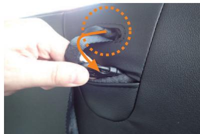
10 2列目背もたれと同様に、シートにカバーをかぶせます。カバー背面にある加工穴からシート固定用ベルトを取り出します。ベルトを収納する際は、加工穴の下にあるスリット部から、純正シートのベルト収納部を使える仕様となります。
