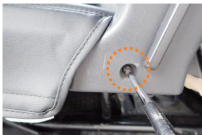
9 隙間が狭く生地が入れ込み辛い場合は、図のように、プラスチックカバーを固定しているネジを、プラスドライバーで緩めると作業がしやすくなります。
