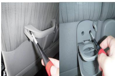
2 プラスチックカバーの中にあるネジとカップホルダーのネジを外します。
