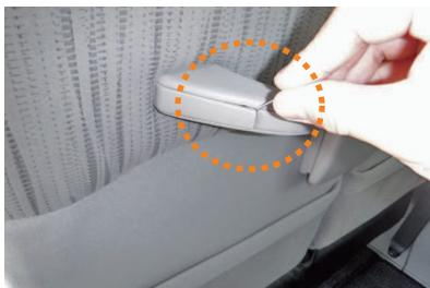
1 最初にバッククリップを外します。
