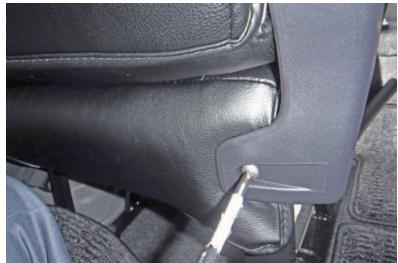
9 プラスチックカバーが付いている所は、ネジを外して生地を隙間に入れ込みます。入れ込んだ後、そのままネジを戻して固定します。（穴開け加工等の必要はありません。）
