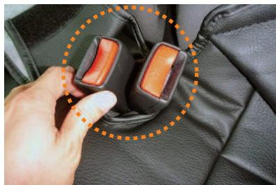
2 中央のシートベルトバックルを、カバーの加工穴から取り出します。
