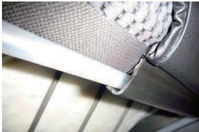
7 プラフックは純正生地に付いているプラスチック部分に上からかぶせて固定します。前後左右に付いているプラフックを同様に固定します。
