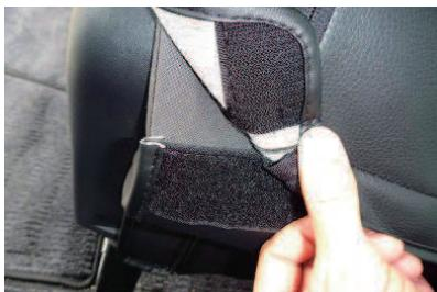
12 引き出した生地とカバー背面下のマジックテープを固定します。
