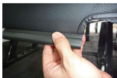
6 生地の端に付いているプラフックを、座面裏のプラスチック部に引っ掛けで固定します。
