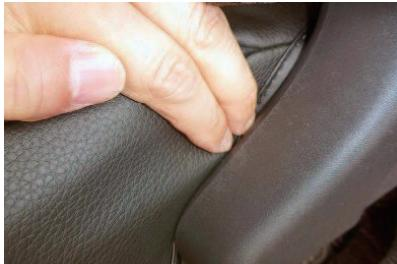
10 側面の生地をプラスチックカバーの隙間に入れ込みます。
