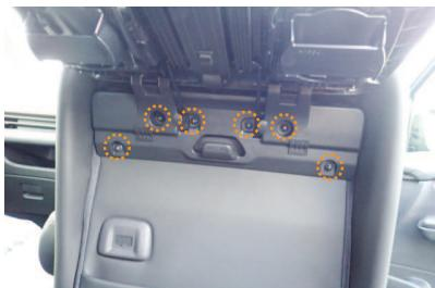
3 次に、背面のバックテーブルを取り外します。バックテーブルを跳ね上げるとナットが6箇所見えます。（図の○位置）ソケットレンチ（8mm）を使用して、ナットを外します。
