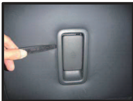
⑩シート背面のシートスライド用レバー部に、ヘラ等を使用し、生地を入れ込みます。
