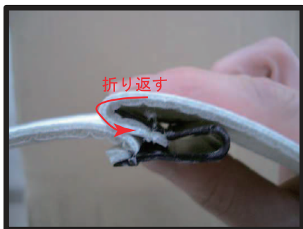
⑧ブラフックの固定方法は、カギ状のフック部に、平らなプラスチック部を、生地ごと巻き込み固定します。
