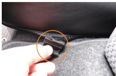
11 カバー内側面の生地裏に付いているプラフックも外側と同様に固定します。
