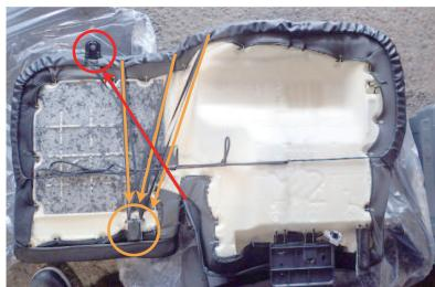
9 カバーに付いている前3箇所と、後ろ1箇所のゴムを金属パーツに引っ掛け固定します。
