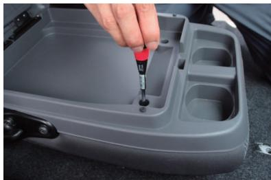
1 ドライバーを使用し、プラスチックボックス内上側2箇所、ボックス外下側2箇所（7番の図参照）のネジの固定を外し、ボックスを外します。
