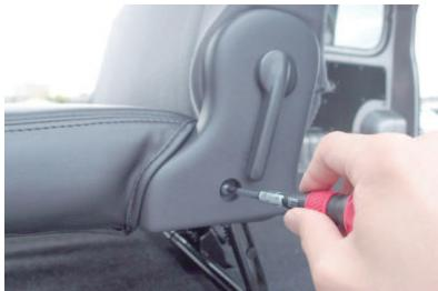
5 ドライバーを使用し、サイドのプラスチックパーツを固定しているネジを締め、カバー側面の生地をシートとプラスチックパートの隙間に入れ込みます。
