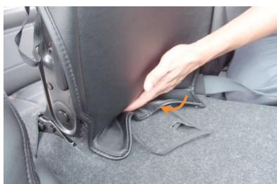
3 生地を背もたれと座面の隙間に入れ込みます。
