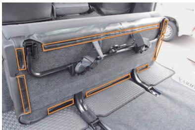
4 図の前後左右の生地裏に付いているマジックテープを、座面裏に貼り付けて固定します。
