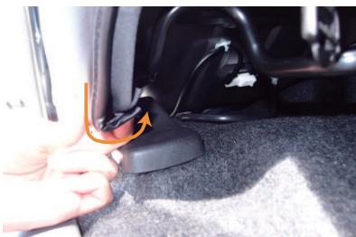
7 カバーの外側面の生地裏に付いているプラフック（2個）を、座面のフチにはめ込み固定します。詳しい固定方法は、8番～10番をご覧下さい。
