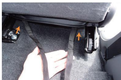
12 カバーの後ろ側に付いているベルトを、座面の下から前側に通します。ベルトを座面の下に入れ込む際は、シートを一番前にスライドさせてから入れ込んで下さい。
