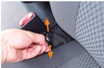
4 シートベルトを固定しているボタンを外します。
