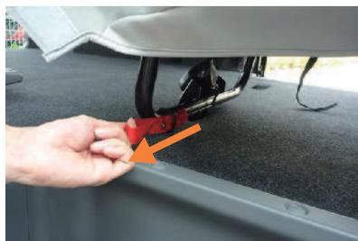
**5** 背もたれを前に倒し、座面後方に付いているベルトを手前に引き、ロックを解除します。
