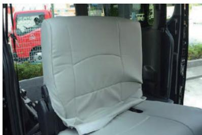
**9** シートのラインに合わせてカバーをかぶせ、1列目背もたれと同様にシートに密着させるようにして、シワをなくしていきます。
