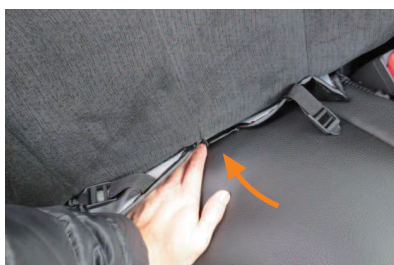
9 背もたれと座面の隙間に生地を入れ込みます。背もたれの角度を調整して、入れ込みやすい位置で生地を入れ込んで下さい。
