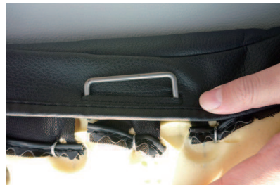
11 シートの中央の付け根部分にあるフックを、 カバーの加工穴に通します。
