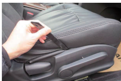
11 シート外側面のシートとプラスチック部の隙間に、ヘアなどを使用して生地を入れ込みます。
