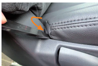
12 シート外側面の角部分も生地を入れ込みます。
