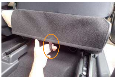
21 運転席側と同様に、シート背面下部の固定を外します。
