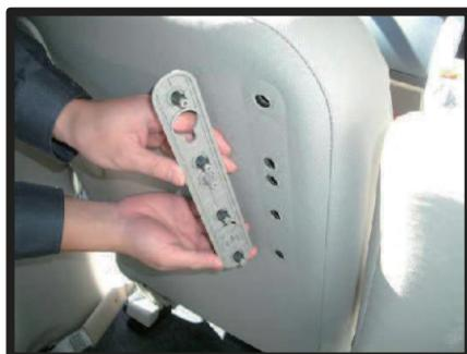
⑫2箇所取り外し、運転席側と同様にカバーを取り付け、最後にマルチポジションレティリティーを元に戻し、助手席背もたれの完成です。
