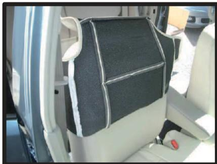
①ヘッドレストを外し、背もたれカバーをかぶせます。マジックテープ部分を折り返して左右均等に引き下げていきます。肩の部分までしっかり入れ込んで下さい。
