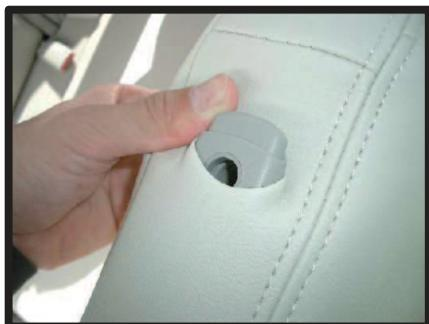
③ヘッドレストの台座部分を穴から取り出します。生地伸びを利用して横からもぐりこみますように取り出して下さい。
