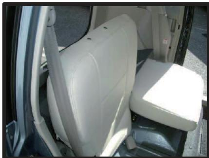
②側面のしわを中央に寄せるようにしてシートとカバーを馴染ませます。
