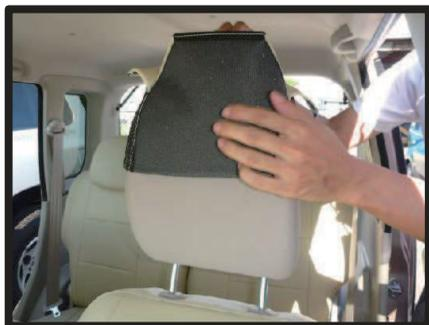
①ヘッドレストカバーの前後を確認してからかぶせます。平らなプラスチックの部品が付いている方が前です。
