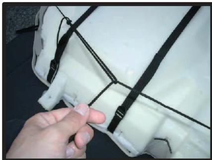
⑤座面左右にある紐を1列目座面と同様に締め付けます。紐はベルトの下をくぐらせるようにします。
