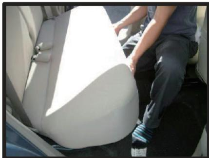
①座面を真上に持ち上げると取り付け部が外れますので、手前に引くことで座面が外れます。
