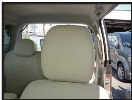
⑤余った生地を重ねるように押し込み、ヘッドレストをシートに取り付けて完成です。2列目も同様に取り付けます。
