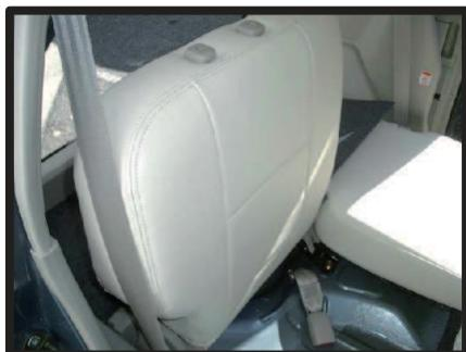
⑨シートのラインがずれていないか確認して2列目背もたれの完成です。助手席後部側も同様に取付けます。
