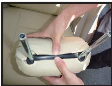
③ヘッドレストを背もたれから取り外し、底面のカバーをかぶせます。
