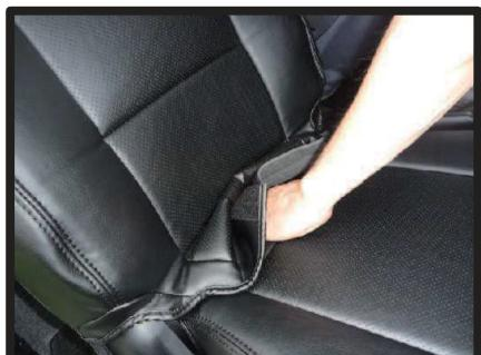
⑥背もたれと座面の隙間に生地を入れ込みます。背もたれの角度を調整して入れ込みやすい位置で行って下さい。
