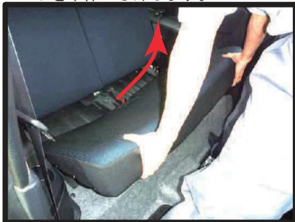
②シート後ろ側の固定を外す為に、シートを矢印の方向へ引いて外します。
