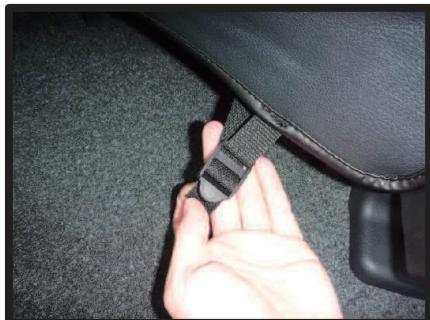
②バックルにベルトを通して、引き絞る事で、カバーが固定されます。
