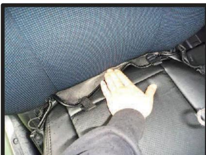
③背もたれと座面の隙間に生地を入れ込みます。背もたれの角度を調整して、入れ込みやすい位置で行って下さい。
