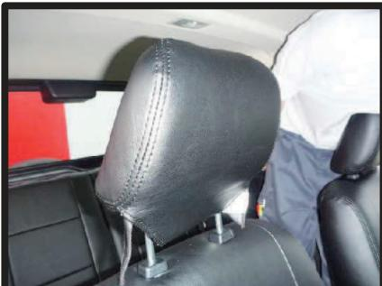
②左右交互に少しずつカバーを引き下げていきます。ヘッドレスト本体をカバーに入れ込むように押さえるのがコツです。
