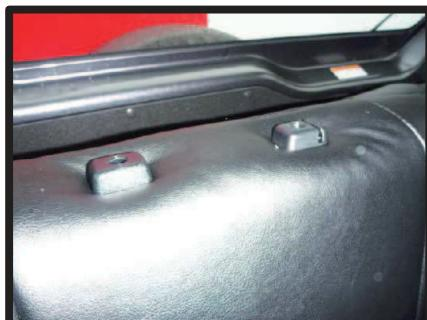
④1列目と同様にしてヘッドレストの台座をカバーの加工穴から取り出します。
