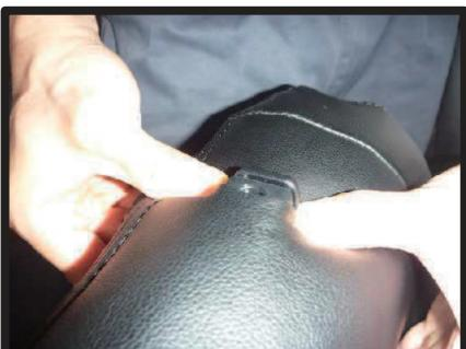
③ヘッドレストの台座をカバーの加工穴から取り出します。まず、片方の角に引っ掛けるようにします。
