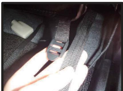
⑥後側から引き出したベルトとバックルを固定します。
