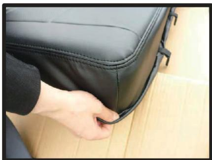
⑥シートのラインからずれないように前側にカバーをかぶせます。
