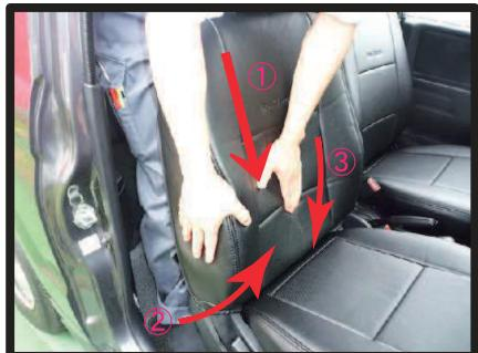
⑤①→②→③の手順で背もたれ側面の生地をシートに馴染ませていきます。側面のシワが消えるまで繰り返し行って下さい。
