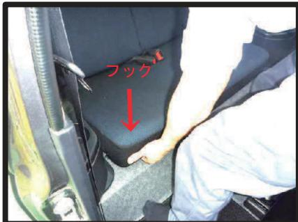
①2列目座面のカバーを取り付ける為にシートを取り外します。シートは図の矢印位置にフック（反対側にもあります）で固定されています。フックの位置あたりを持ち上げて、シートを車体から外します。
