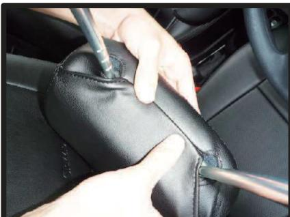
③ヘッドレストをシートから取り外し、底面のフックを固定します。
