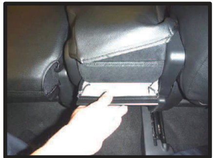
③入れ込んだ生地をシート背面から引き出して、プラフックで固定します。
