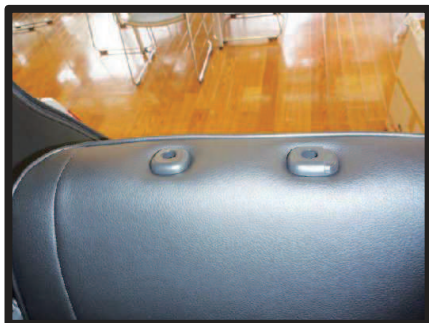
④ヘッドレストの台座を取り出します。
