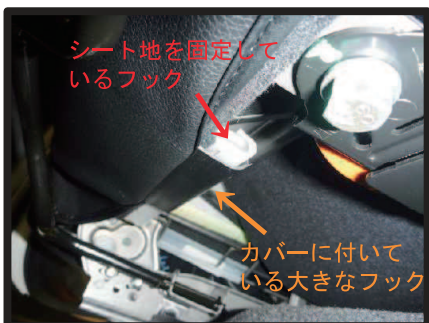
⑰フックはシート裏の、シート地を固定している白いフックの上から引っかけて固定します。
