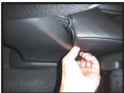
⑳助手席側も形状は違いますが、ほぼ運転席側と同様に固定します。カバーの内側面のみ固定方法が異なります。助手席側内側面の後部にゴムが付いています。ゴムはシートとプラスチック部の隙間に入れ込みます。
