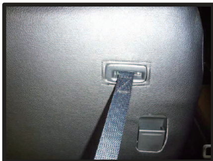
⑤シート背面のベルトをカバーの加工穴から出します。
