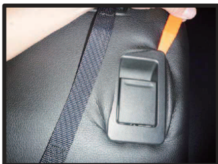
⑥シート背面のリクライニングレバーのフチに、ヘラなどを使用して生地を入れ込みます。
