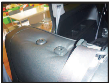
⑨ヘッドレストの台座を取り出します。
