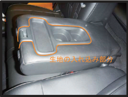
⑤図のドリンクホルダーなどのフチにヘラなどを使用して生地を入れ込みます。
