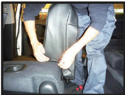
⑦シートのラインに合わせて、カバーをかぶせます。
