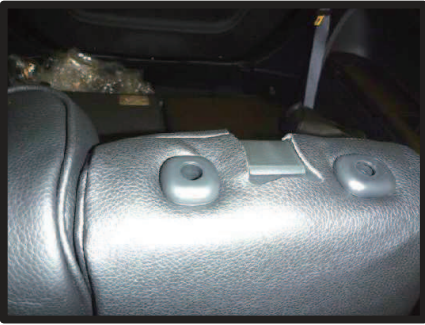
④ヘッドレストの台座を取り出します。
