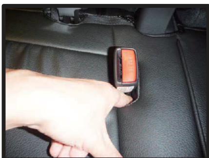
⑱シートベルトバックルのフチに生地を入れ込みます。
