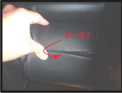
④シート背面から、生地を引き出してカバーをプラフックで固定します。
