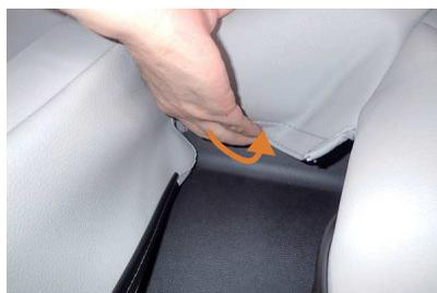
14 アームレスト収納部分の上側に、カバーの生地を沿わせながら入れ込みます。カバーの端の生地裏に付いているマジックテープを、直接シートに貼り付けて固定します。
