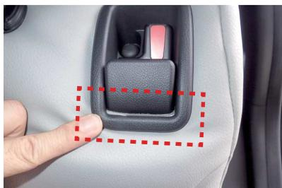
9 リクライニングレバーの前側に生地を入れ込み過ぎると、レバー部分が生地に引っ掛かる場合があります。レバーの動作を確認して、生地が引っ掛かるようであれば、入れ込んだ生地を少し引き出し、レバーと干渉しないようにして下さい。
