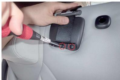
10 中央席のシートベルトが出てくるプラスチックパーツの図のネジを、ドライバーを使用して緩めます。
