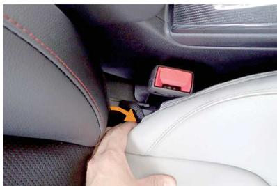
9 シートの外側と同様に、シート付け根部分の端に付いているゴムを生地と一緒に図の隙間に入れ込みます。
