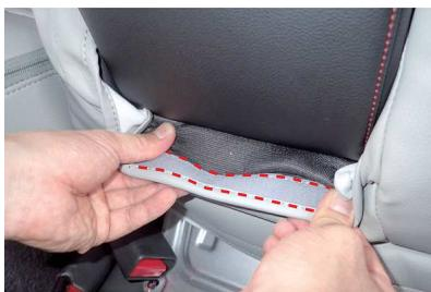
18 アームレストを起こした状態の付け根部分です。カバーの端の生地裏にマジックテープ（赤線部分）が付いています。
