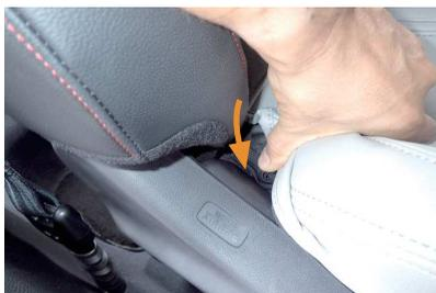
7 シート付け根部分に、生地端に付いているゴムを生地と一緒に図の隙間に入れ込みます。
