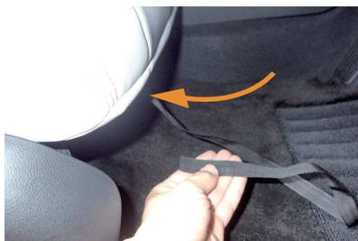
12 シートの前側からカバーの端に付いている2本のベルトをシート裏へ入れ込みます。※ベルトはシートの裏側にあるパーツをかわしながら、できる限りパーツの上側を通すようにして下さい。
