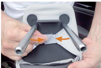
10 ヘッドレストをシートから外します。ヘッドレスト裏で生地を内へ寄せながらマジックテープを固定します。
