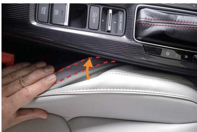
8 シートの内側です。シート内側のカバーの端には、生地裏にマジックテープが付いています（赤線部分）。シートとコンソールの隙間に生地を入れ込み、マジックテープを直接シートに貼り付けて固定します。
