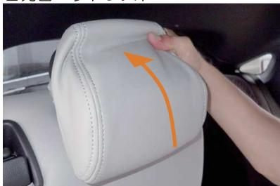
8 図の矢印方向に、ヘッドレストのラインに合わせて下から上へかぶせます。カバーは平らなプラスチックが付いている方が前です。
