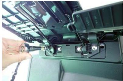
40 シートバックテーブル装備車はテーブルを元通りに固定します。
