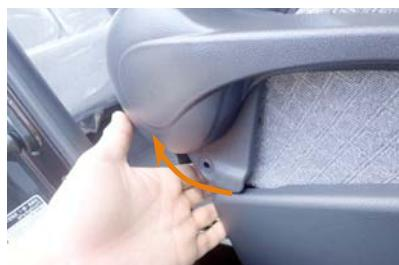
6 ネジを外してプラスチックパーツを斜め上に引くと、図のようにシートからプラスチックパーツが少し浮くように出てきます。この状態にして次の作業に移ります。
