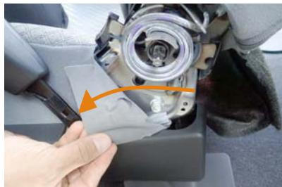
10 プラスチックパーツ内側の純正のシート表皮を、図のようにめくります。この状態でシートカバーの装着を行っていきます。
