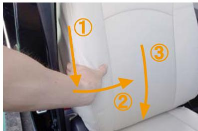
6 ①～③の順番に、カバー側面の生地を引き下げるながら中央へ寄せて、中央で余った生地を下へ撫で下ろします。シートの下に余った生地を⑤番と同様にシート裏から引き出して、生地をシートに密着させていきます。
