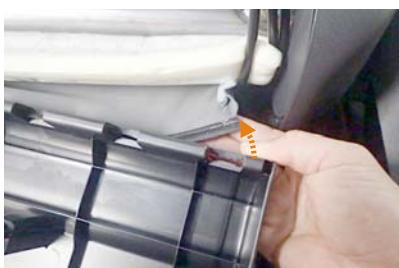
14 13番の部分を隙間を広げながら生地を引くと、図のように固定部材が外れていきます。
