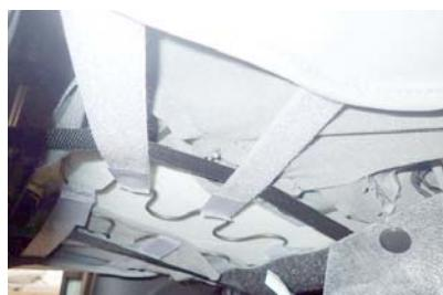
12 マジックテープベルトをシート裏の金属部分に巻き付けて固定します。
