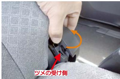
8 ネジが留まっていたプラスチックパーツを外します。図のシートの表面側から見た位置にプラスチックパーツのツメがあります。ツメの位置を意識して上へめくり上げるようにして外していきます。
