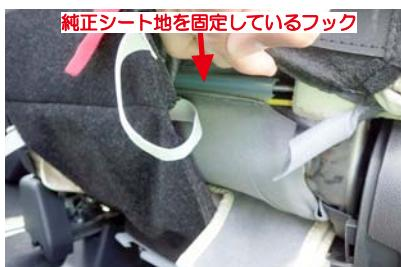
8 シート背面の5ページ4番で固定を外した生地を少々強引にめくり上げた図です。図の矢印の辺りに純正シート地を固定しているフックがあります。
