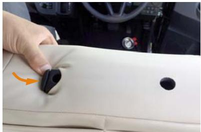
2 ヘッドレストの台座を取り出します。まず台座の片側のフチに生地をしっかりと入れ込みます。
