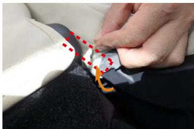
15 マジックテープをカバー内側の点線部分に付いているマジックテープと固定します。
