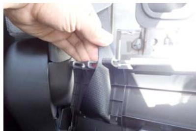
16 シートベルトをボードの隙間に通して外します。
