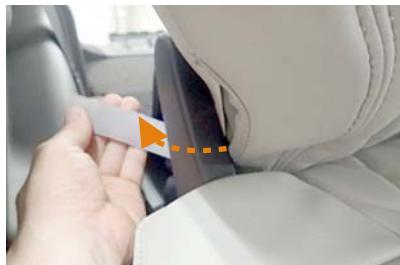
4 シート外側の軸部分です。カバーの端にマジックテープが付いています。マジックテープを軸の内側を通して、シートの背面から引き出します。
