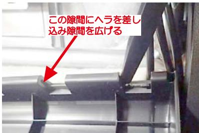
13 バックボード下側のシート表皮の固定を外します。
