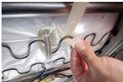
20 マジックテープのベルトはシート裏の金属部分に巻き付けて固定します。
