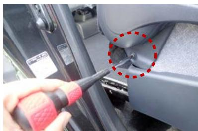
5 シート外側のリクライニングレバーの下にあるネジを、ドライバーを使用して外します。
