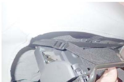
7 23ページ6番で引出したベルトを、カバー外側の前側に付いているバックルに通して固定します。
