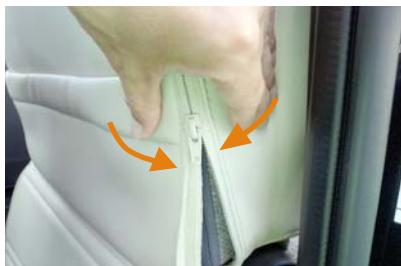
7 カバーの両側面に付いているファスナーを生地を内へ寄せながら慎重に閉じます。ファスナーの端はカバーの中へ入れ込みます。
