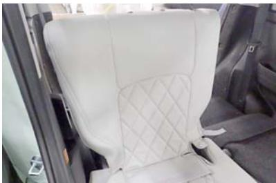
1 カバー側面のファスナーを開いた状態にして、シートのラインに合わせてカバーをシート全体にかぶせます。
