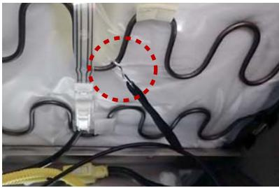
13 引き出したゴムに付属の金属フックを取り付けます。金属フックをシート裏の金属部分に引っ掛けて固定します。
