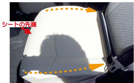
3 カバーをシートのラインに合わせて前側から後ろ側へ向けてかぶせます。シートの先端まで生地が張るようにしっかりととかぶせて下さい。
