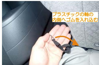
17 23ページ2番で引っ掛けた生地の端にゴムが付いています。ゴムに付属の金属フックを取り付けてシート裏へ入れ込み、シート裏の金属部分に引っ掛けで固定します。ゴムは図のプラスチックの軸の内側を通しシート裏へ入れ込むようにして下さい。
