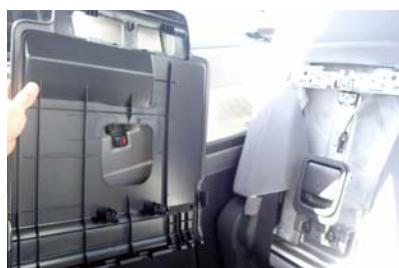
17 シートからバックボードが外れました。バックボードは車内に置いておくと作業の邪魔になり、破損させる恐れもあるので、車外へ運び出しておくようにして下さい。
