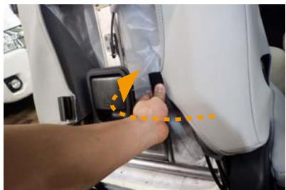
26 カバー側面の生地をシートに馴染ませながら、シート背面で純正シート地を固定しているフックの上から、カバーのフックを引っ掛けで固定します。
