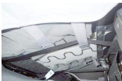
9 マジックテープベルトをシート裏の金属部分に巻き付けて固定します。
