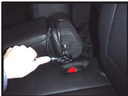
⑭アームレストを本体に戻します。 外した時と逆の手順で固定します。
