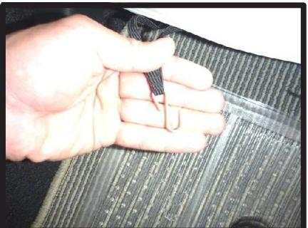
⑯シートの背面から、カバー側面の後方に付いているゴムに、付属のS字フックを取り付けます。
