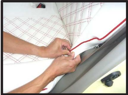
⑬シートを起こします。表面の生地が内へ寄っている場合があるので、カバーを側面の角に引っかけるようにして、シートのラインに合わせます。
