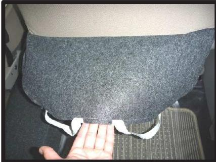
①図はシートの背面下部分です。始めにシート裏のゴムを外して、図の部分をめくれるように外しておきます。
