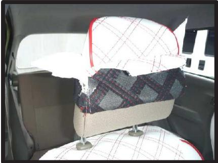
①カバーを裏返して、ヘッドレストのラインに合わせてかぶせます。この際、ヘッドレストの先端の生地がしっかりと張るようにかぶせて下さい。
