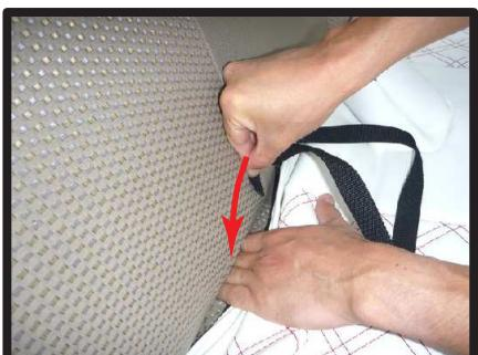
⑥カバーの後方に付いているベルトを背もたれと座面の隙間に入れ込みます(計4本)。
