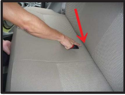
③シートは車体から完全に外した方がカバーの取り付けは行いやすいのですが図の矢印位置のフックが大変外れにくいため、このフックは外さずカバーの取り付けを行います。
