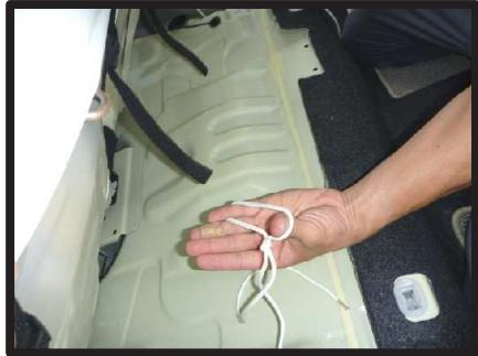
⑭カバー側面から出ているヒモの片側で、図のように輪を作ります。
