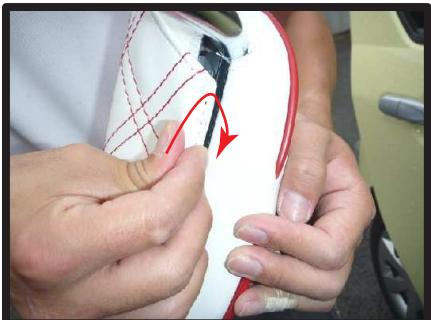
③ヘッドレストをシートから外して、ヘッドレスト裏でフックで固定します。
