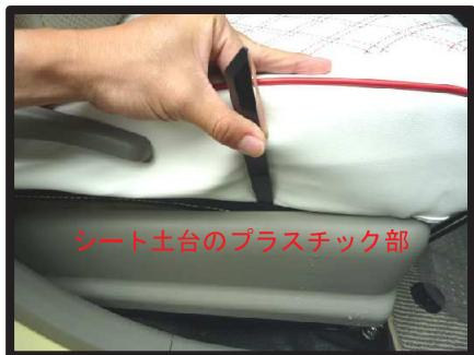
⑨カバー外側面のプラスチックの板をシートとシート土台のプラスチック部の隙間にに入れ込みます。
