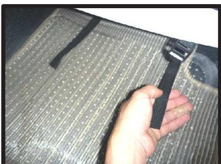
⑰シート背面からベルトを引き出します。ベルトを2ページ⑧で引き出した生地に付いているバックルに通して固定します。
