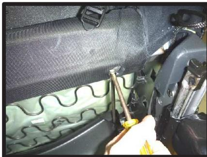
②助手席にシートアンダートレイが装備されている車両は、①のゴムがトレイのレールに引っかかっている場合があります。その場合はドライバーを使用して、レールを固定しているネジを、シート背面側だけ外してゴムを外して下さい。
