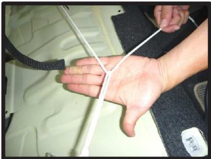
⑪もう片側のヒモを作った輪に通してシート下回りを絞り込み結び留めます。
