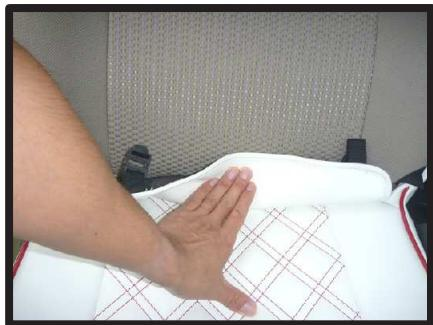
⑦背もたれと座面の隙間に生地を入れ込みます。背もたれの角度を調整して、入れ込みやすい位置で行って下さい。
