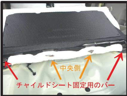
⑫シート背面下は図のようになります。両端のチャイルドシート固定用のバーには、生地がかからないようにして下さい。中央側のバーは加工穴に通して下さい。
