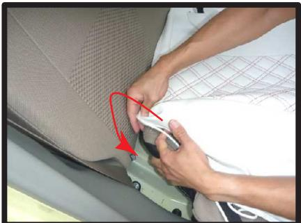
④始めにシートの付け根の角にカバーをかぶせます。シートを左右にずらして、隙間を作りながら作業を行って下さい。
