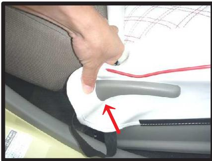
③カバーをかぶせます。リクライニングレバーにカバーの加工穴を通しておきます。穴は小さめに開けています。矢印部分のレバーのフチに、生地をしっかりと入れ込みます。
