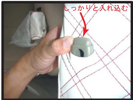
④ヘッドレストの台座をカバーの加工穴から取り出します。まず台座の片側のフチに生地をしっかりと入れ込みます。
