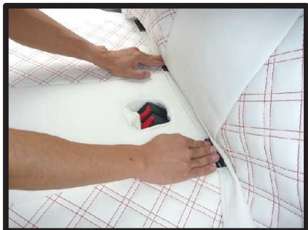
⑦背もたれと座面の隙間に生地を入れ込みます。生地にはフックが付いているので、フックで生地を傷付けないようにご注意下さい。
