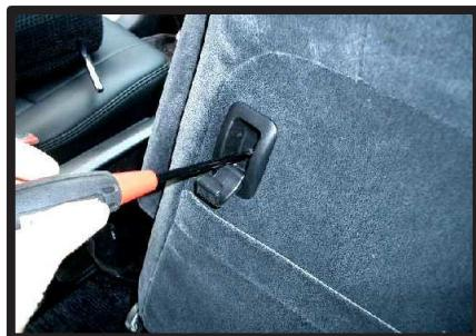
①ネジを外します。ツメで固定されている場合がありますので、取り外しには十分ご注意ください。ツメが破損すると元通りに取り付けられなくなる場合もあります。
