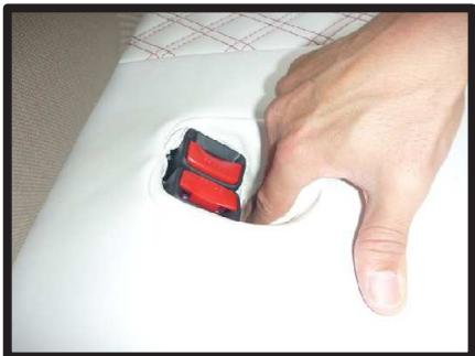
⑬シートを元の状態に戻します。シートベルトバックルのフチに生地を入れ込みます。
