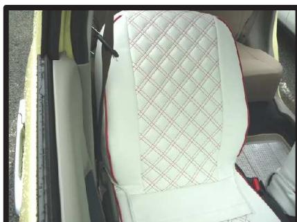
③シートのラインからずれないようにカバーを左右均等に引き下げて、シート全体にかぶせます。
