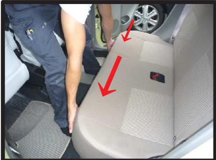
①2列目座面は、シート前方のフックを外した状態でカバーの取り付けを行います。
