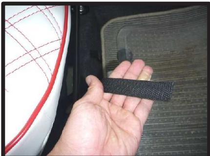
⑮カバー前方に付いているベルトを、シート裏を通してシート背面へ回します。
