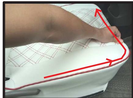
⑤始めに通したリクライニングレバー部分を軸として、カバーを矢印方向にかぶせます。
