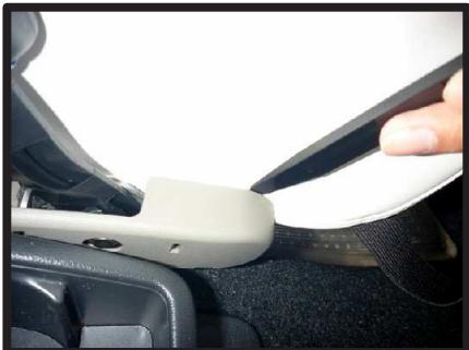
⑯カバー内側面の後方側です。プラスチック部のフチに生地を入れ込みます。
