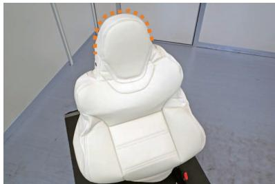
1 カバー側面のファスナーを開けた状態で、シートのラインに合わせて先端（図の点線部分）部分の生地がしっかりと張るようにかぶせます。
