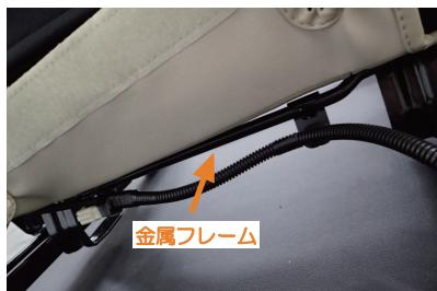
6 生地は矢印部分の金属フレームの上側を通して引き出します。
