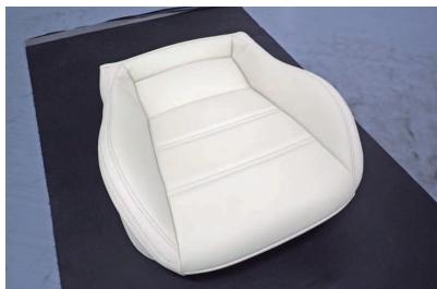
20 カバーのラインを整えて、運転席座面の完成です。シートは背もたれカバー装着後、元のフレームに戻します。配線などを戻し忘れないようにご注意下さい。
