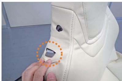
2 シートベルトガイドを固定していた肩口の図の金属部分を、シートの加工穴から取り出します。
