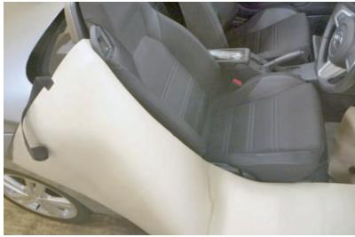
7 シートを車外へ運び出す際は、車体に傷など付けたりしないように、車体部分やステアリングを養生しておくことをお勧めします。
