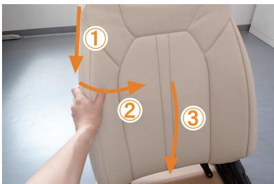
8 ①~③の順番にシート側面の生地を中央に寄せてなで下ろし、シートに密着させていきます。側面の張り出しが大きいシートなので、繰り返し行い側面にシワなどが残らないように馴染ませて下さい。
