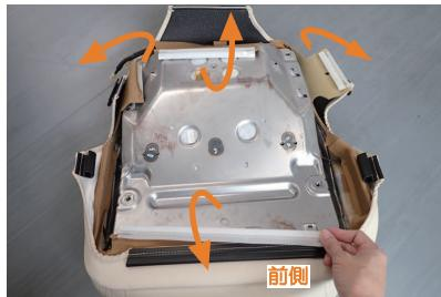
16 クッション裏でシート表皮を固定しているフックを前後左右4カ所外します。外したシートの表皮とフックはカバーの内側へ入るようにします。
