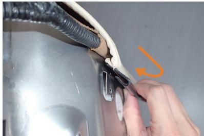
17 シート表皮を固定していたフックが掛かっていた金属部分に、カバーのフックを引っ掛けます。
