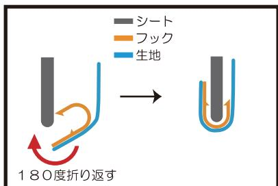
20 19番の手順をイラストで説明します。シート本体の端に、フックを生地と共に180度向きを変えた状態で、差し込み固定します。
